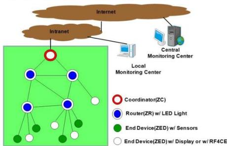
Fig. 2. ZigBee Network
