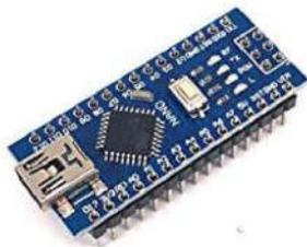
**Fig no: 3 C-TYPE CH 340 NANO CONTROLLER**
