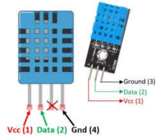
Fig3: DHT11 Sensor
