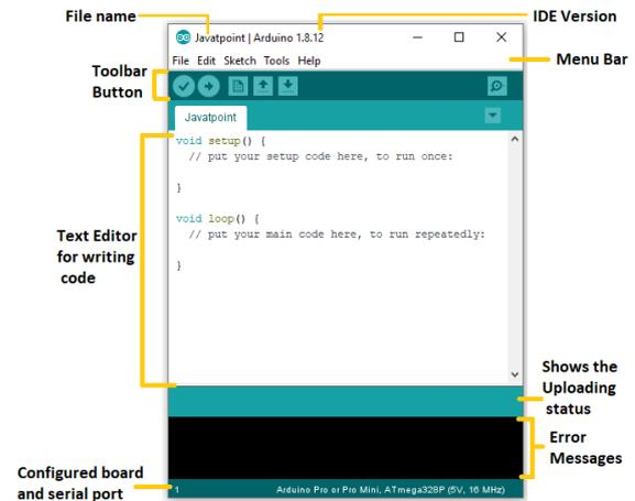
**Fig7: Arduino IDE Window**
