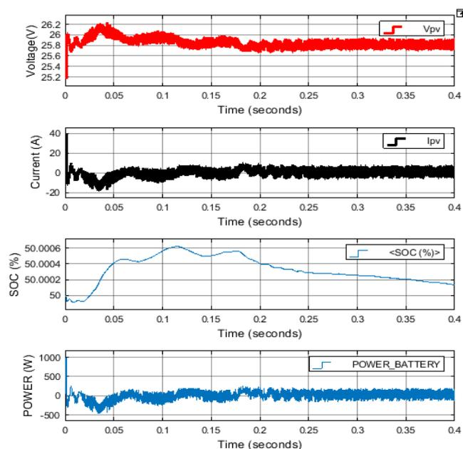
Fig 11- Battery output parameters
