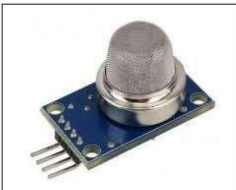
**Fig. 5. MQ3 Gas Sensor**
