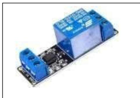
**Fig. 8. Relay Module**
